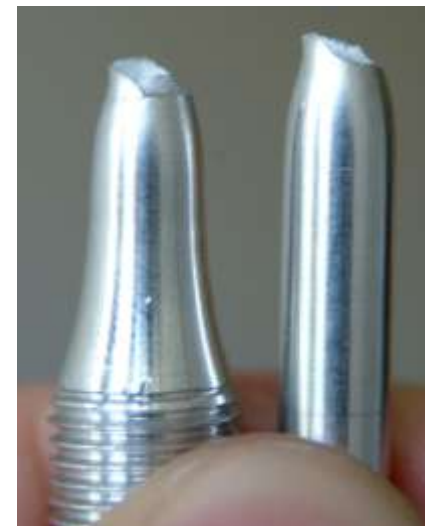
Μεταλλικό δοκίμιο μετά το τεστ μηχανικής αντοχής
