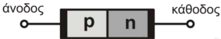
Τυπική κατασκευή p-n διόδου
