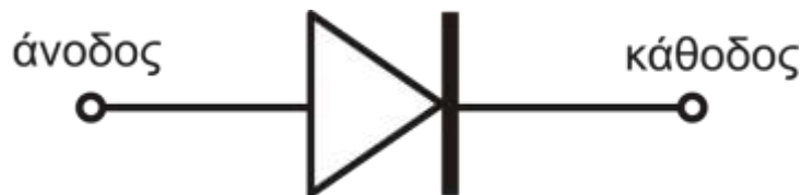
γραφική απεικόνιση p-n διόδου σε ηλεκτρικό κύκλωμα
