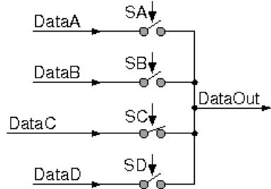
Το ποιά είσοδος επιλέγεται μπορεί να αλλάζει "δυναμικά", δηλαδή την ώρα της λειτουργίας του κυκλώματος, και γιά να γίνεται η επιλογή αυτή ο πολυπλέκτης έχει άλλες, επιπλέον εισόδους, τις εισόδους ελέγχου (control inputs) ή εισόδους επιλογής (selection inputs), που εδώ είναι οι SA, SB, SC, και SD. Στο απλό κύκλωμα πολυπλέκτη που δείχνουμε εδώ, η επιλογή εισόδου γίνεται με τον εξής τρόπο: ανά
