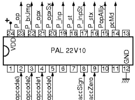
Κατασκευάστε το κύκλωμα ελέγχου του απλού υπολογιστή, χρησιμοποιώντας την παραπάνω PAL καθώς και δικά σας chips γιά το (ένα) flip-flop κατάστασης, γιά έναν αντιστροφέα γιά το bit κατάστασης, και γιά μερικές πύλες AND και OR που θα χρειαστείτε. Θα χρειαστείτε ένα κοινό ρολόϊ που να τροφοδοτεί τόσο το δικό σας
