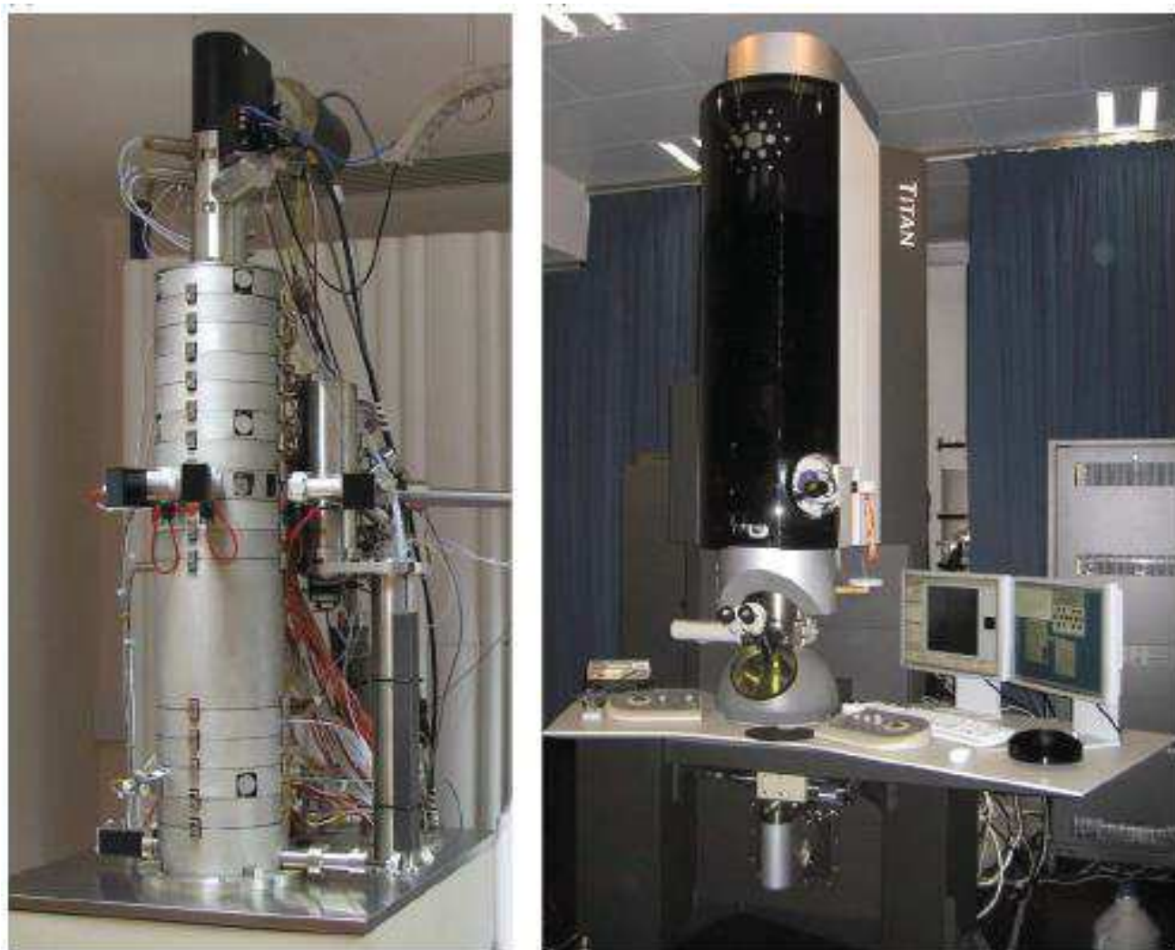
Σχήμα 2.7 (ε-ζ). (ε) Nion 200 keV UHV Super STEM; το μοναδικό κατασκευασμένο στις ΗΠΑ με την μέχρι πρόσφατα μεγαλύτερη Δ.Ι., (ζ) Το Titan της εταιρίας FEI.
