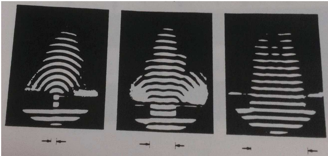
Σχήμα 13. Επίδραση διαφράγματος στην διάδοση των κυμάτων.
