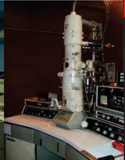
Συμβατικό Ηλεκτρονικό Μικροσκόπιο Διέλευσης JEOL 100 CX (100 KV) με διακριτική ικανότητα καλύτερη από 0.5 nm και υποδοχείς δείγματος με δυνατότητα ψύξης, θέρμανσης και εφέλκυσμού.
