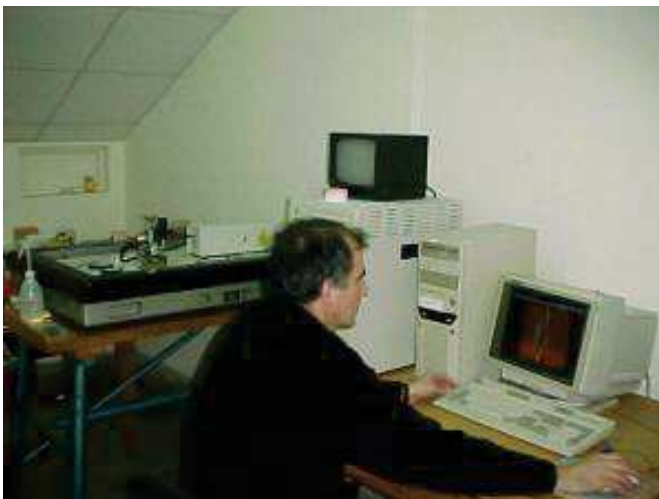
Μικροσκόπιο Ατομικών Δυνάμεων (AFM) Explorer 2000 Truemetrix Topometrix, δύο σαρωτών των 100 \mu\text{m} x 100 \mu\text{m} , 2.5 \mu\text{m} x 2.5 \mu\text{m} και υγρό σαρωτή των 2.5 \mu\text{m} x 2.5 \mu\text{m} με ανάλυση μερικών nm
