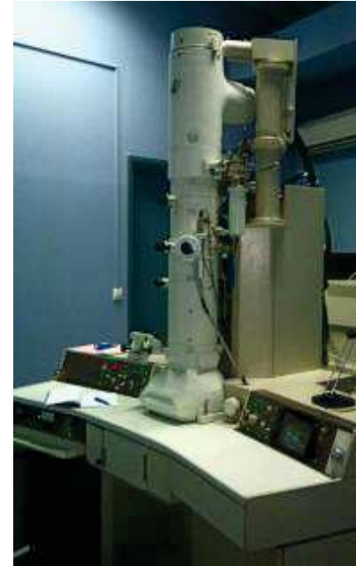
Ηλεκτρονικό Μικροσκόπιο Διέλευσης Υψηλής Ανάλυσης JEOL 2011 (200KV), με διακριτική ικανότητα 0.194 nm
