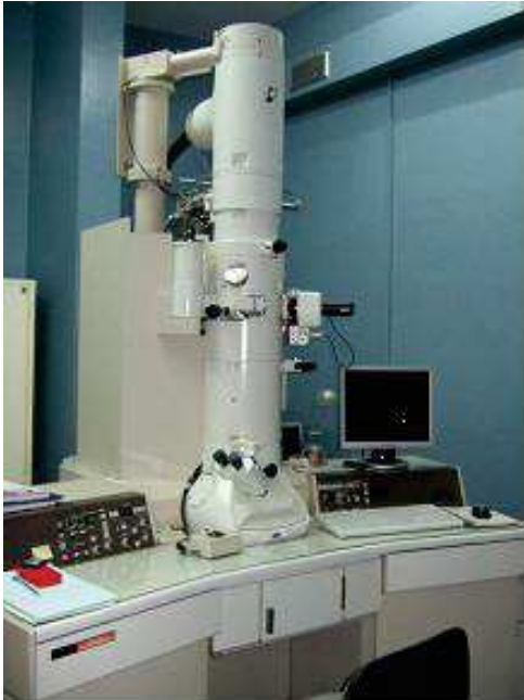
Ηλεκτρονικό Διέλευσης Υψηλής Ανάλυσης JEOL 2000FX (200KV), με διακριτική ικανότητα 0.28 nm
