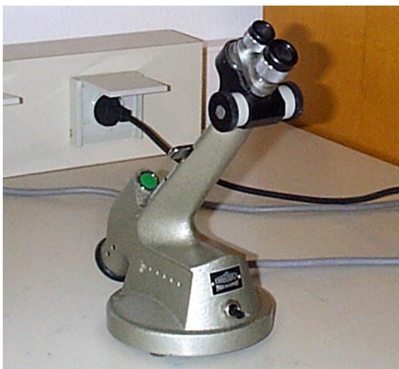
Σχήμα 3. Φωτογραφία του πολωσίμετρου που θα χρησιμοποιηθεί στο πείραμα
